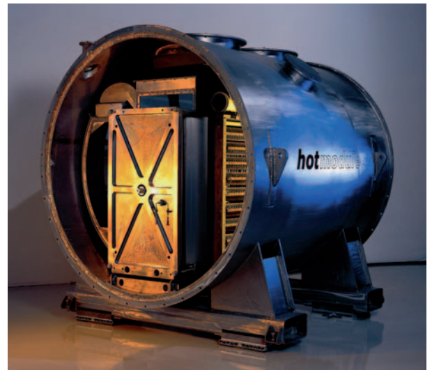
Abb. 1: HotModule im Bau: Einbau des Brennstoffzellenstapels
