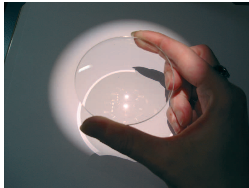
Abb. 5: Die beim Blick durch die Zeisslampe sichtbar werdenden Schatten deuten auf einen nicht gleichmäßigen Abtrag hin. Der Polierprozess muss fortgesetzt werden. Die Mathematik kann helfen, an dieser Stelle den Produktionsprozess zu verkürzen
