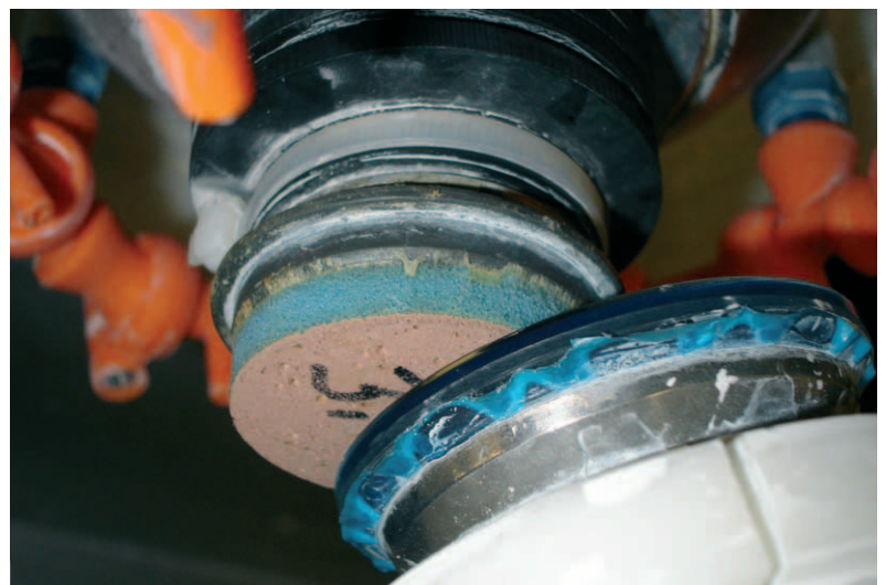
Abb. 4: Ein an einer frei beweglichen Pinole befestigtes rotierendes Polierpad muss über ebenfalls rotierenden Träger, auf dem das Gleitsichtbrillenglas befestigt ist, so gesteuert werden, dass ein gleichmäßiger Abtrag entsteht, durch den das Brillenglas erst durchsichtig wird
